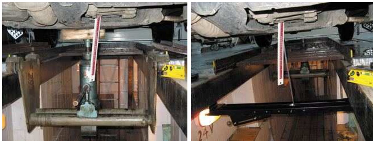
Rys.: Sposób odciążania (po lewej) i dociążania (po prawej) zawiesznień dla dokonania pomiarów zgodnych ze szczególnymi wymaganiami producenta pojazdu.
