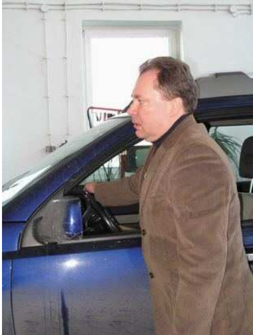
Rys.: Pierwszą czynnością po wprowadzeniu pojazdu na stanowisko jest orientacyjne ustawienie przednich kół w kierunku „na wprost”
