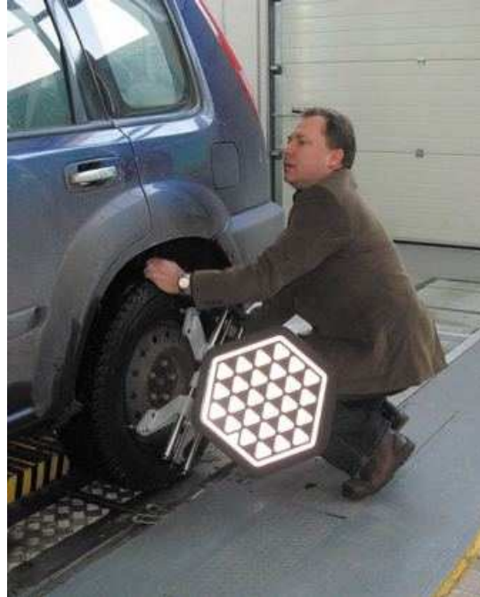
Rys.: W następnej kolejności blokujemy obrotnice oraz mocujemy do wszystkich kół uchwyty i pasywne głowice, które dokładnie poziomujemy
