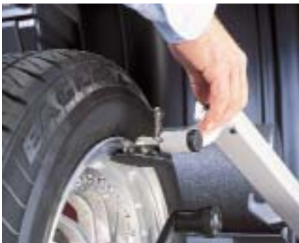
Kontrola osiowej i promieniowej niejednorodności kształtu obręczy
