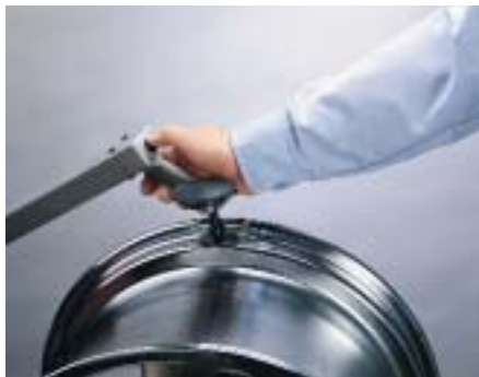
Kontrola osiowej i promieniowej niejednorodności kształtu obręczy
