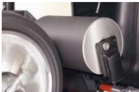
Niejednorodność kształtu opon, np. stożkowe zużycie (z prawej), generuje siły poprzeczne, które mogą wzajemnie się znosić. Na zdjęciu u góry – rolka do kontroli kształtu opony, stanowiąca wyposażenie nowoczesnej wyważarki
