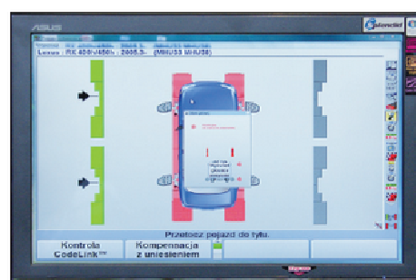
Rys.: Po kompleksowym sprawdzeniu geometrii wyważenia kół program „podpowiada” kolejne etapy procedury kalibracyjnej
