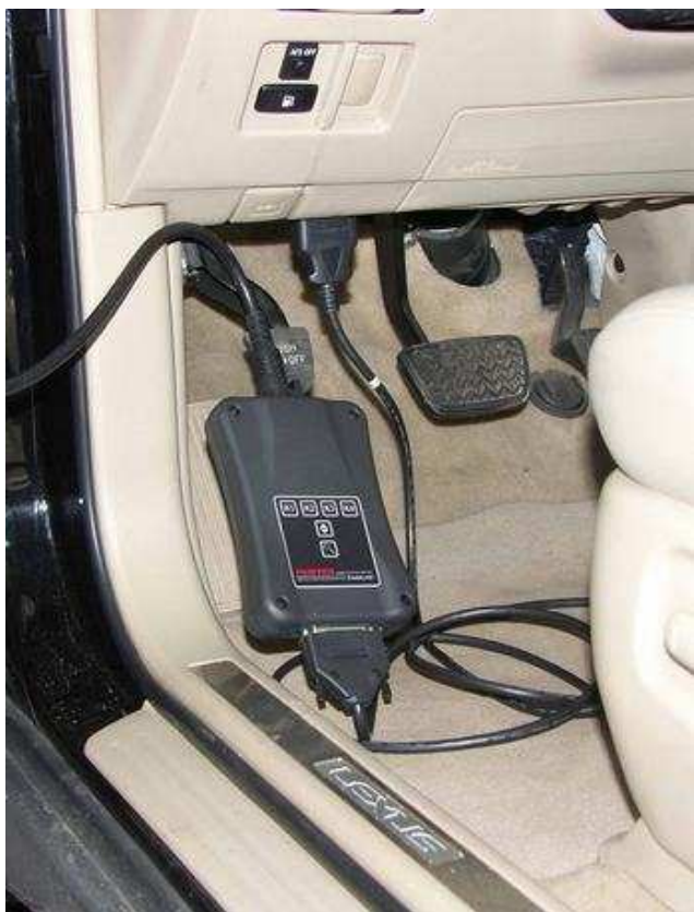
Rys. (po lewej i poniżej): Moduł CodeLink™ podłącza się do gniazda diagnostycznego samochodu na stanowisku do kontroli geometrii podwozia
