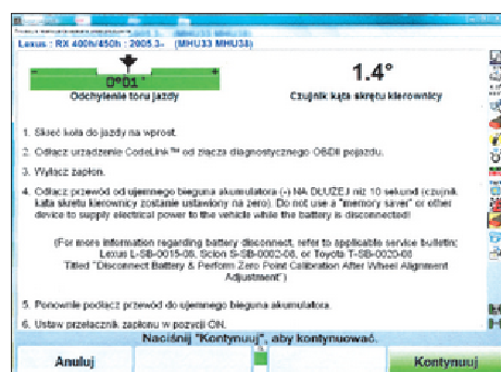
Rys.: Po kompleksowym sprawdzeniu geometrii wyważenia kół program „podpowiada” kolejne etapy procedury kalibracyjnej
