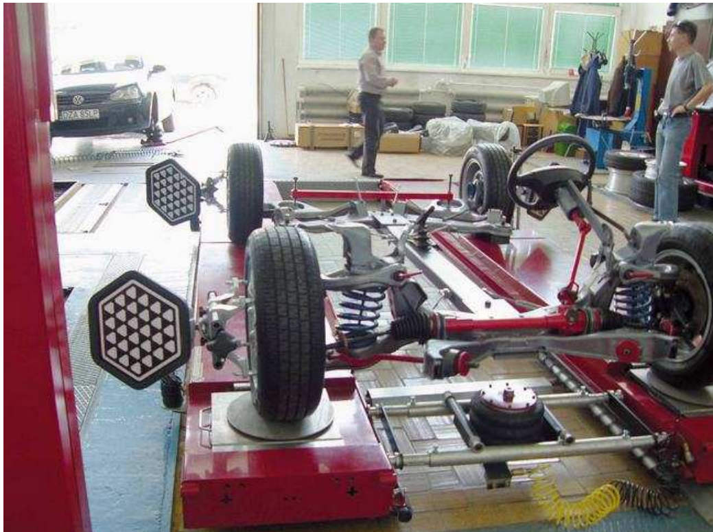
Głowice pasywne HS 400 podczas pomiaru geometrii ustawienia kół
