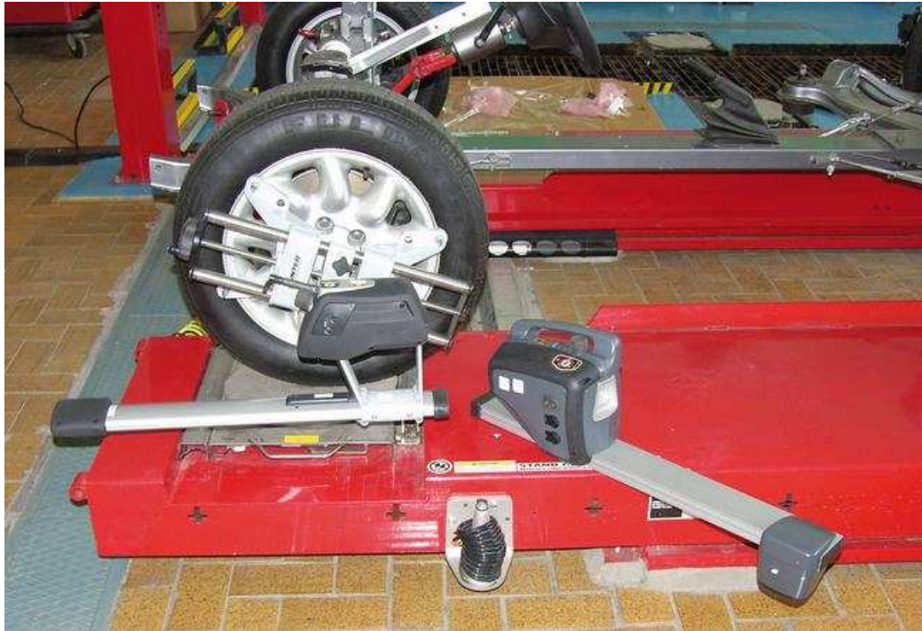
Nowy model głowicy DSP 700 (z prawej) w porównaniu z głowicą aktywną DSP 500 produkowaną obecnie
