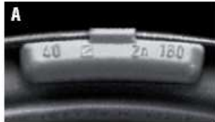
CIĘŻAREK STALOWY POWLEKANY BEZ ŚLADÓW KORYZJI (A) I Z JEJ ŚLADAMI (B)
