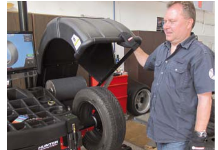
12. Opuszczenie osłony koła uruchamia procedury pomiarowe, których wyniki pojawiają się kolejno na ekranie. Cały cykl pomiarów trwa ok. 20 sekund
