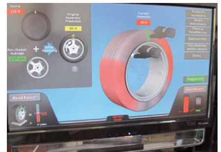
18. Dyskwalifikacja opony z powodu jej zbyt niejednorodnej sztywności
