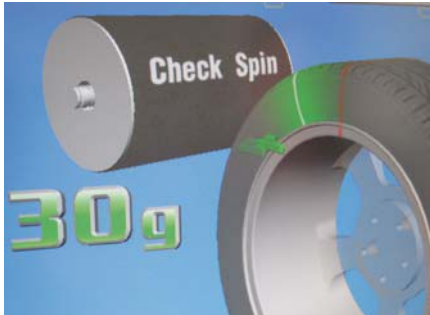
13. Najpierw odbywa się pomiar niewyważenia z podaniem wagi potrzebnego ciężarka i jego miejsca na obręczy
