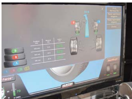
19. Rolka w ramach tzw. testu drogowego mierzy też boczne znośzenie koła i ewentualne drgania poprzeczne
