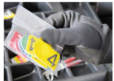
21. Do identyfikacji kół służą kolorowe, numerowane zawieszki, osadzone na zaworach powietrznych
