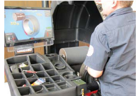
15. Lokalizację i masę ciężarków można zoptymalizować, uruchamiając na ekranie funkcję SmartWeight
