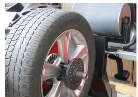
24. Do kół z alufelgami służy specjalny system mocowania ich na wrzecionie i program rozmieszczający klejone ciężarki za sprychami
