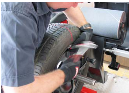
16. Ciężarek po stronie zewnętrznej (gdy jest on potrzebny) mocuje się również według danych z ekranu i laserowej linii na kole
