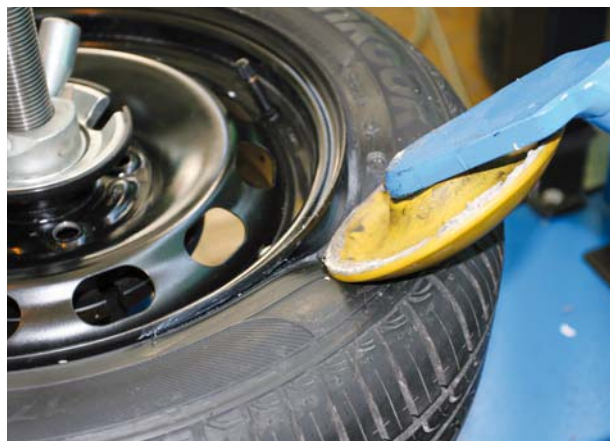
FOT. 2. WIDOK ROLKI-TALERZA MONTAŻOWNICY PODCZAS BOCZNEGO ROLOWANIA OPONY
