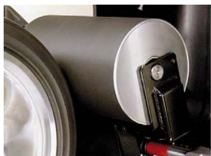
FOT. 1. INTERPRETACJA GRAFICZNA ZMIENNEJ SIŁY PROMIENIOWEJ GENEROWANEJ PRZEZ OBCIĄŻONE KOŁO ORAZ POMIAR ZRÓŻNICOWANEJ SZTYWNOŚCI NA WYWAŻARCE DIAGNOSTYCZNEJ Z TESTEM DROGOWYM
