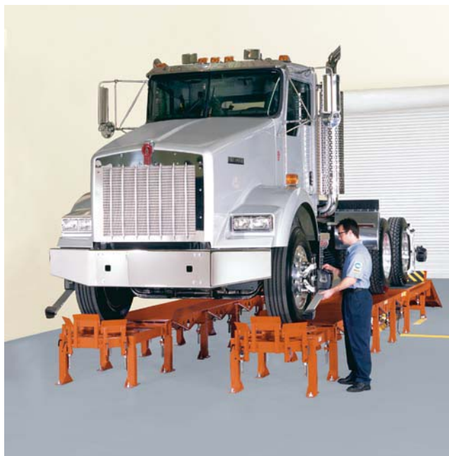
ROZWIĄZANIE ALTERNATYWNE WZGLĘDEM TRADYCYJNYCH KANAŁÓW ZAGŁĘBIANYCH W PODŁOGACH WARSZTATÓW
