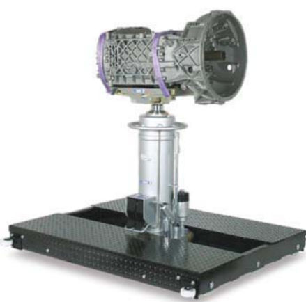
ZASTOSOWANIE PODNOŚNIKA KANAŁOWO-PODŁOGOWEGO DO DEMONTAŻU LUB MONTAŻU CIĘŻKIEJ SKRZYNI BIEGÓW
