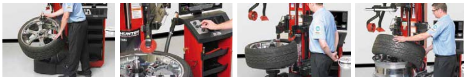
CZYNNOŚCI OBSŁUGOWE OPERATORA MONTAŻOWNICY: 1. ZAKŁADANIE I ZDEJMOWANIE KOŁA, 2. USTAWIANIE PARAMETRÓW (ŚREDNICA, POŁOŻENIE CZUJNIKÓW TPMS I ZAWORU), 3. OBSERWOWANIE PRZEBIEGU PROCEDURY, 4. WYMIANA ZDJĘTEJ OPONY NA NOWĄ
