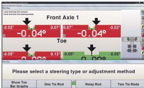
POMIAR ZBIĘŻNOŚCI KÓŁ PRZEDNICH OSI ZA POMOCĄ OPATENTOWANEJ PROCEDURY WINTOE
