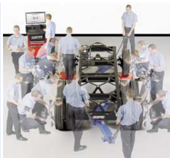
TRADYCYJNA PROCEDURA BADANIA GEOMETRII I ODPOWIADAJĄCE JEJ CZYNNOŚCI DIAGNOSTY
