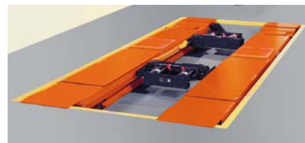
DŹWIGNIKI NOŻYCOWE: POWYŻEJ – DO MONTAŻU NA POSADZCE WARSZTATU, OBOK – W WERSJI ZAGŁĘBIONEJ W PODŁODZE
