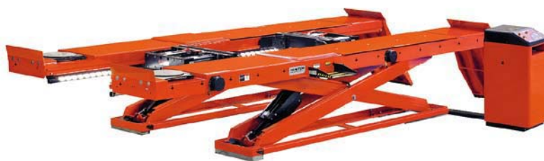
DŹWIGNIKI NOŻYCOWE: POWYŻEJ – DO MONTAŻU NA POSADZCE WARSZTATU, OBOK – W WERSJI ZAGŁĘBIONEJ W PODŁODZE
