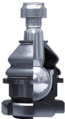
BUDOWA TYPOWEGO PRZEGUBU (SWORZNIA) KULOWEGO STOSOWANEGO W ZAWIESZENIACH I UKŁADACH KIEROWNICZYCH
