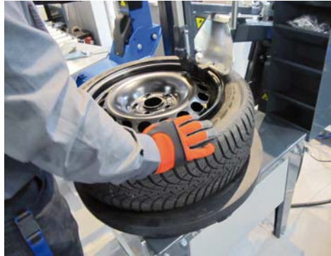
OSOBNY ZBIJAK LEMIESZOWY UPRASzcZA WSTĘPNĄ FAZĘ DEMONTAŻU OPON I PÓŹNIEJ-SZĄ OBSŁUGĘ MONTAŻOWNICY
