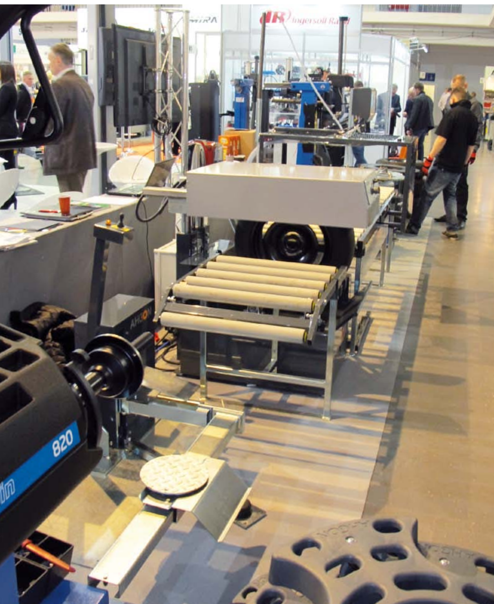
SYSTEM AHCON TO PRZEDĘ WSZYSTKIM ZESTAW PROSTYCH URZĄDZEŃ DO ERGONOMICZNEGO TRANSPORTU KÓŁ W POZIOMIE I PIONIE
