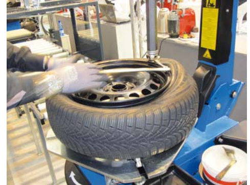
DEMONTOWANE KOŁO PRZESUWANE JEST PO ROLKACH ZE ZBIJAKA NA DOWOLNĄ MONTAŻOWNICĘ (TU MODEL WYMAGAJĄCY POMOCY TRADYCYJNEJ ŁYŻKI)
