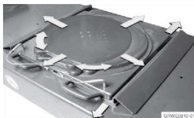
RYS. 3. PRZYKŁAD OBROTNICZY MECHANICZNEJ WYMAGANEJ PRZY BADAANIACH SAMOCHODÓW BMW
