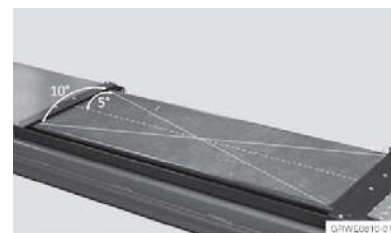
RYS. 4. PŁYTA PRZESUWNA UMOŻLIWIĄCA BOCZNE I SKRĘTNE PRZEMIESZCZENIA KÓŁ
