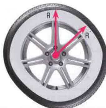
R > R' : promień opony zamocowanej na obręczy i napompowanej nie jest idealnie regularny. Bicie promieniowe = R_{max} - R_{min}
