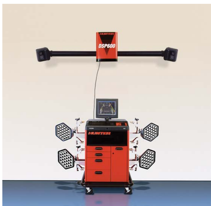
Fot. 1. Podstawowymi elementami układu DSP 600 do pomiaru geometrii zawieszona są: stelaż z zamontowanymi z czterema kamerami i układem oświetlającym oraz tzw. pasywne głowice, montowane na koła pojazdu.
