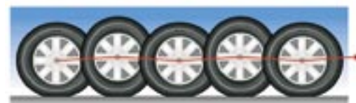
Bicie promieniowe powoduje, że piasta koła nie porusza się po linii prostej, lecz oscyluje w kierunku pionowym. Przy obciążeniu opony powoduje to wahanie sił promieniowych na piastę koła.
