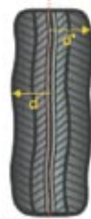
R > R' : promień opony zamocowanej na obręczy i napompowanej nie jest idealnie regularny. Bicie promieniowe = R_{max} - R_{min}
