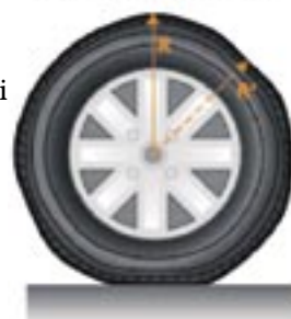
R > R' : promień opony zamocowanej na obręczy i napompowanej nie jest idealnie regularny. Bicie promieniowe = R_{max} - R_{min}
