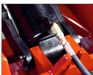
Zamek hydrauliczny zabezpieczający dźwignik w przypadku nagłego obniżenia ciśnienia.
