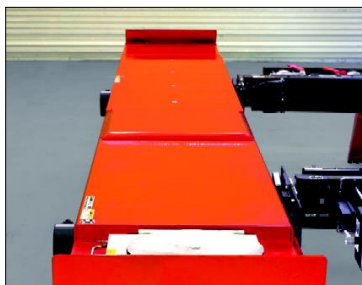
Szerokie platformy (610mm) ułatwiające wjazd. Obrotnice blokowane mechanicznie lub pneumatycznie (automat).
